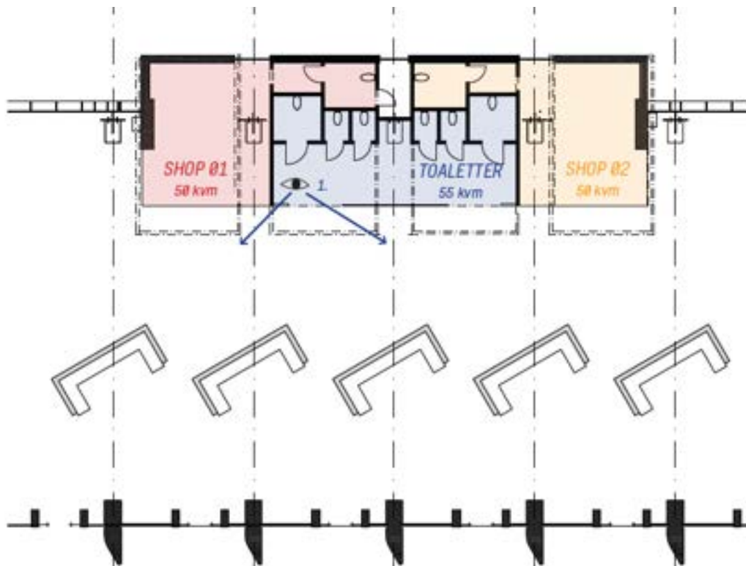
Bild 18 Toaletterna följer samma modulära system som de kommersiella lokalerna, Sweco Architects
